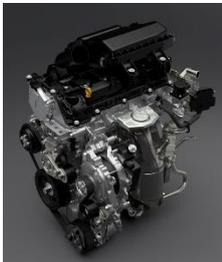
Der überarbeitete K12D 1.2 DUALJET-Motor, der den neuen Ignis antreibt, verfügt über ein neues Doppelspritzsystem und bietet sowohl ein kraftvolles Ansprechverhalten als auch eine hohe Kraftstoffeffizienz. Die hochwertige Abstimmung war durch verschiedene Weiterentwicklungen möglich, einschliesslich einer elektrischen variablen Einlassventilsteuerung (VVT), einer Öl-Verstellpumpe und elektrischen Kolbenkühlösen.
